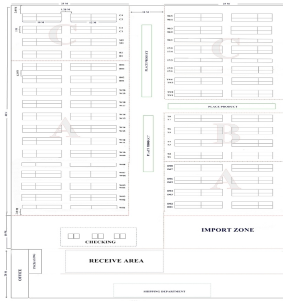
ภาพที่ 2 คลังสินค้าออกแบบโดยแบ่ง กลุ่ม ABC แบบแนวขวาง
